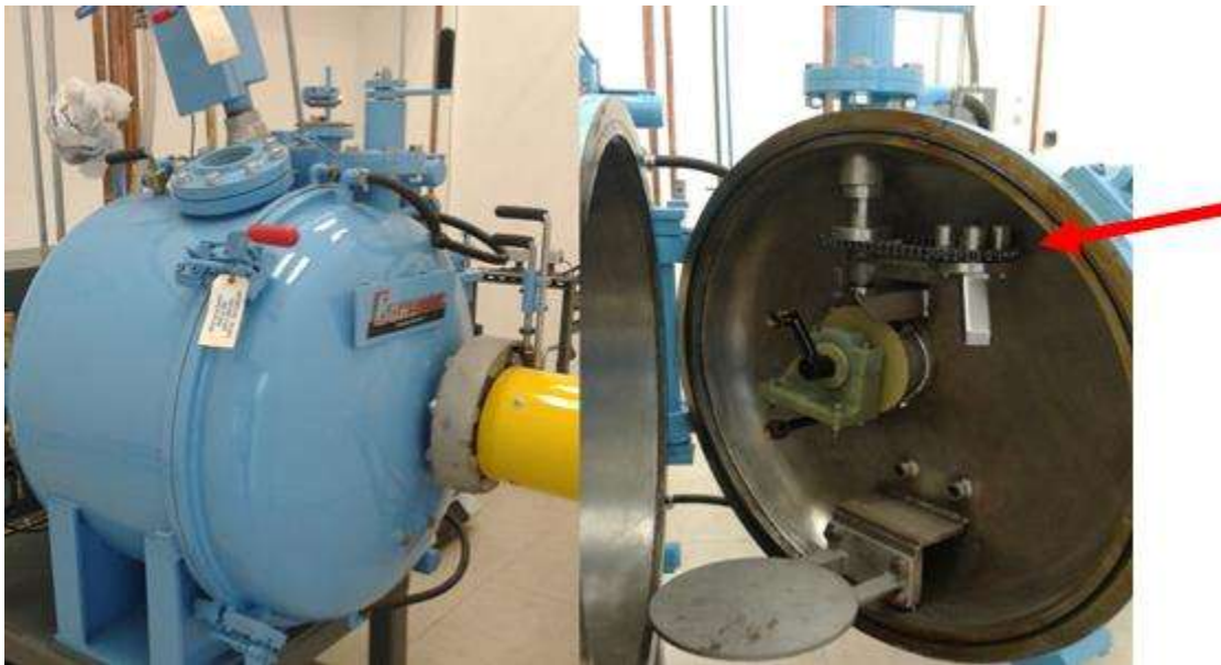
Figura 3. 1 Horno de inducción VIF-CONSARC.
