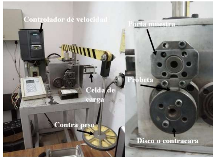
Figura 3. 19. Máquina de desgaste por deslizamiento mediante la configuración bloque sobre anillo giratorio.
