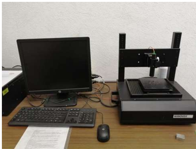
Figura 3. 18. Perfilometro óptico marca Nanovea modelo Ps50
