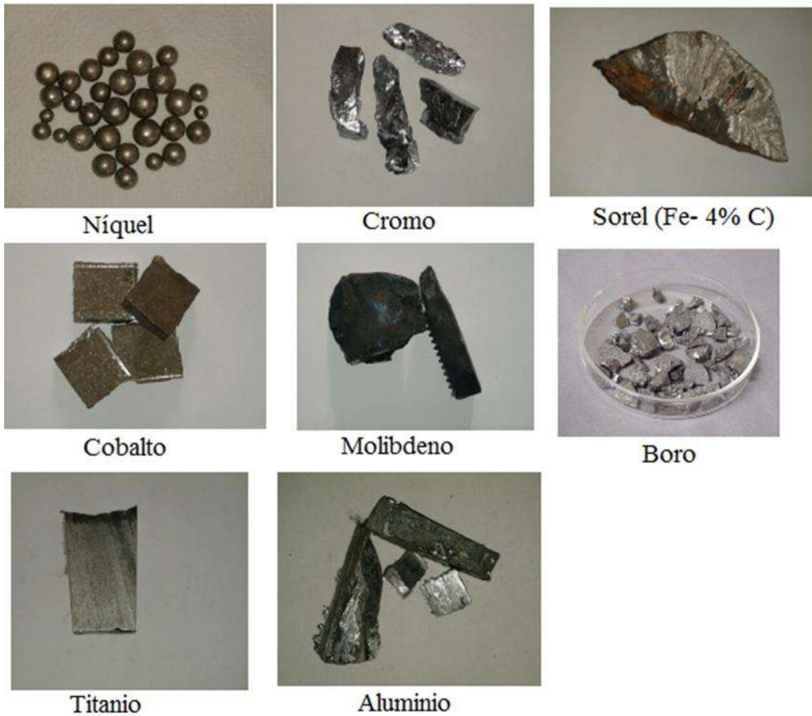
Figura 3. 2. Materiales de aleación antes de cargar el horno para la fusión.
