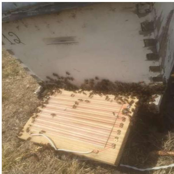
El día martes 3 de abril se colocó en la piquera la trampa colectora implementando un voltaje de 1.5 a 12 volt. Durante 10 minutos con intervalos de descargas de 6 segundos y 10 segundos de descanso a la colonia 2.
