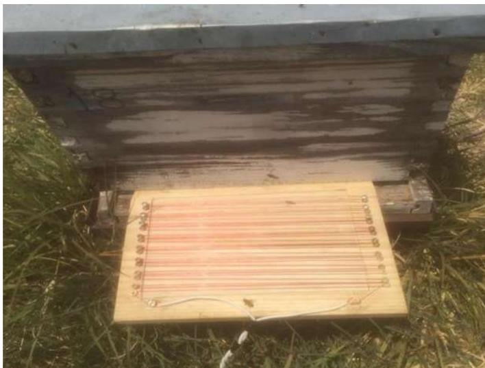
El día martes 3 de abril se colocó en la piquera la trampa colectora implementando un voltaje de 1.5 a 12 volt. Durante 10 minutos con intervalos de descargas de 6 segundos y 10 segundos de descanso a la colonia 3.
