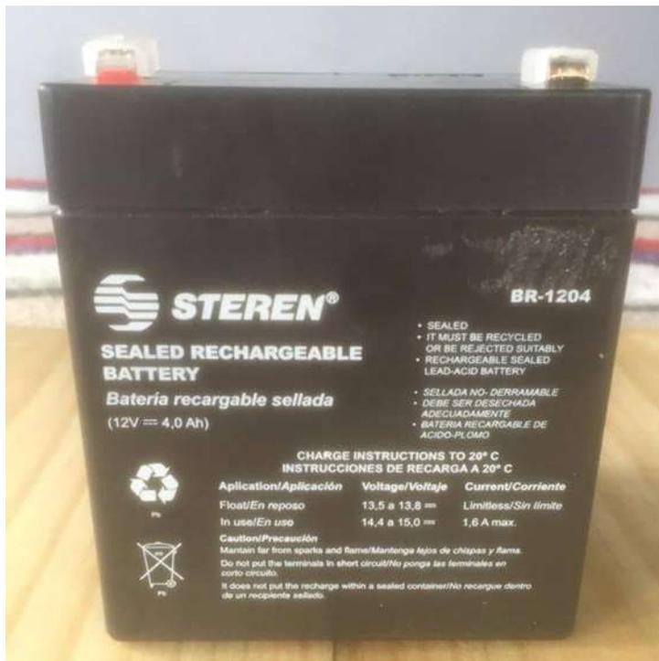
Batería sellada recargable de 12 volt 4 amperes con duración de 6 horas.
