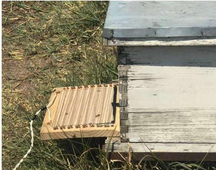
El día jueves 5 de abril se colocó trampa colectora de veneno en la piquera implementando un voltaje de 1.5 a 12 volt. Durante 10 minutos con intervalos de descargas de 6 segundos y 10 segundos de descanso a la colonia 3.
