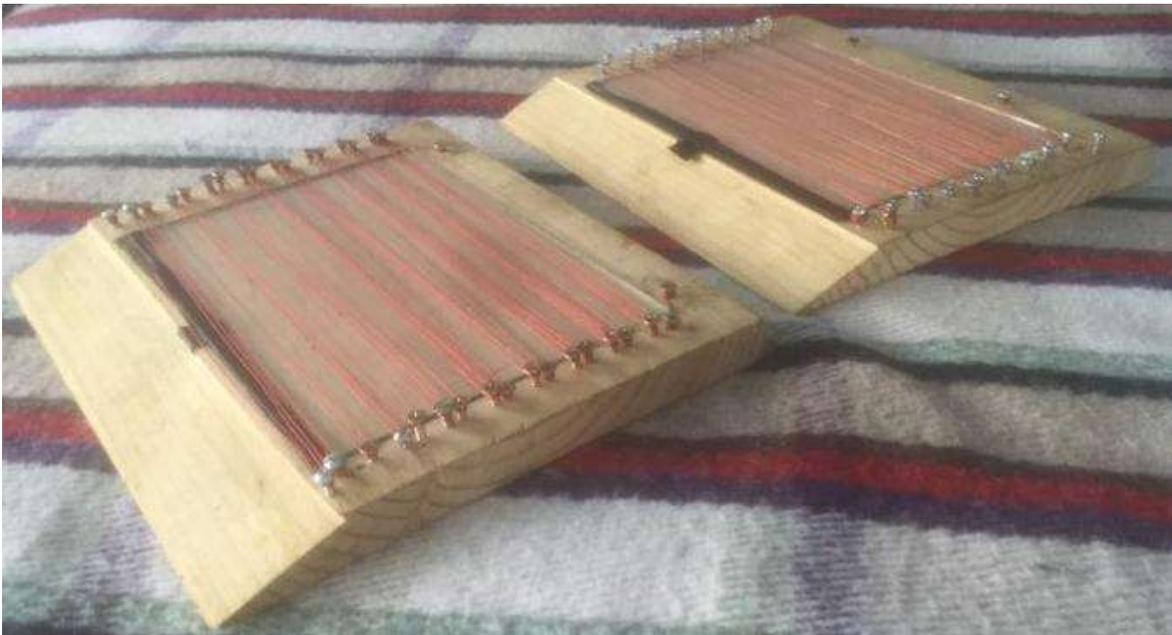
Trampas elaboradas con madera, tornillos, alambre de cobre y hendidura para el vidrio.
