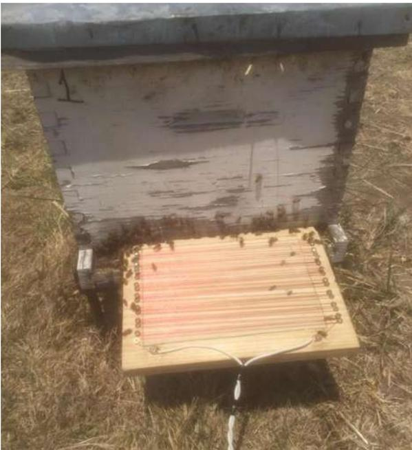
El día martes 3 de abril se colocó en la piqueta la trampa colectora implementando un voltaje de 1.5 a 12 volt. Durante 10 minutos con intervalos de descargas de 6 segundos y 10 segundos de descanso a la colonia 1.
