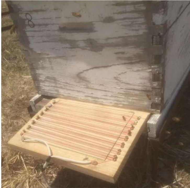
día martes 3 de abril se colocó en la piquera la trampa colectora implementando un voltaje de 1.5 a 12 volt. Durante 10 minutos con intervalos de descargas de 6 segundos y 10 segundos de descanso a la colonia 4.
