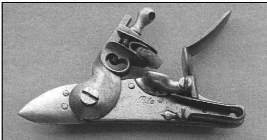
Llave de Pedernal o sílex. Puede apreciarse los elementos que conforman una llave: la pletina, la piedra de pedernal montada en el pie de gato y la cazoleta junto al rastrillo. Fotografía Colección del MNI-INAH. 68
