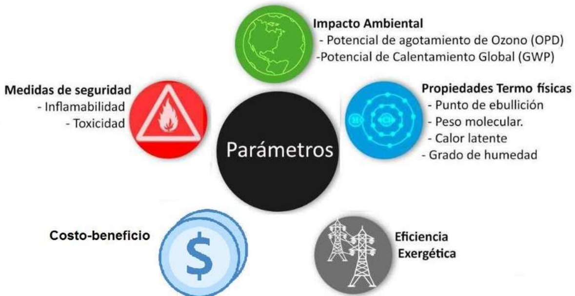
Figura 68. Matriz de decisión para la selección del fluido de trabajo.
