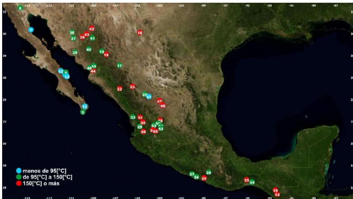
Figura 23. Ubicación de zonas geotérmicas susceptibles de aprovecharse para generación distribuida, autoabastecimiento y cogeneración en México.
