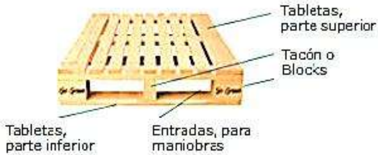
Figura 2. Componentes de una tarima de tacón
