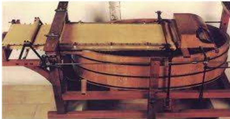
Figura 3 Máquina diseñada por Robert en 1799 (Coll, 1962)
