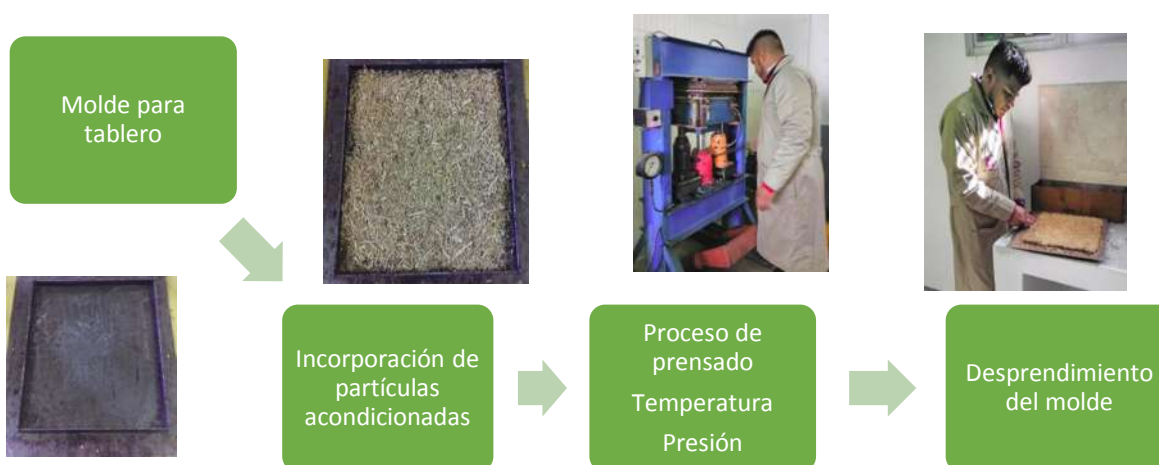
Figura 11. Esquema de fabricación de tableros de partículas de madera.
