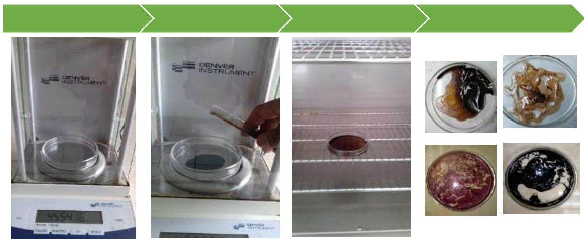
Figura 26. Determinación de la densidad método volumétrico.
