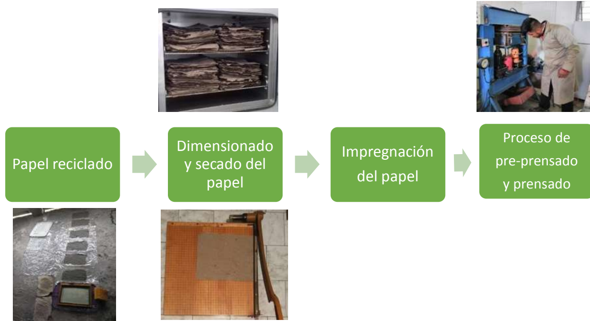
Figura 13. Esquema de proceso de Elaboración de tablero (Panel) de fibras recicladas de madera.
