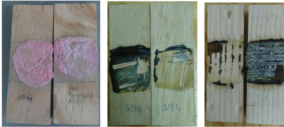
Figura 20. Resultados obtenidos de la evaluación de la tensión en la resistencia a la unión adhesiva.
