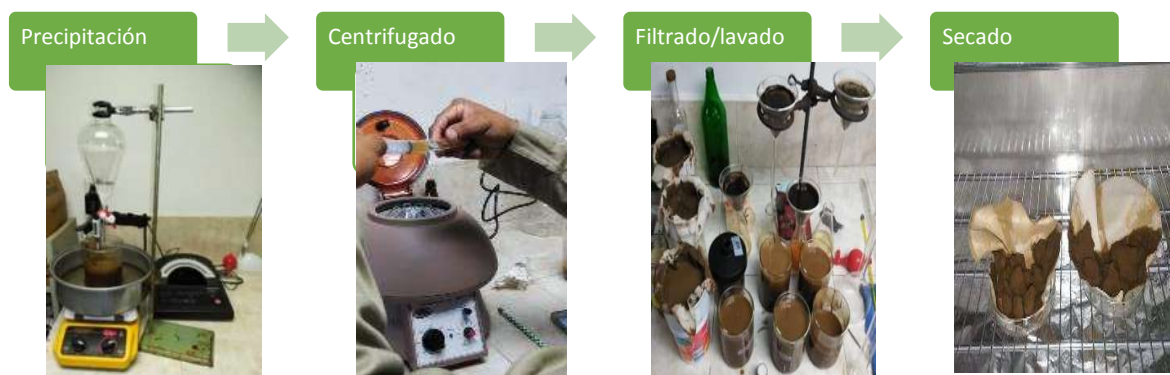
Figura 22. Precipitación centrifugado filtrado y lavado, y secado de lignina.
