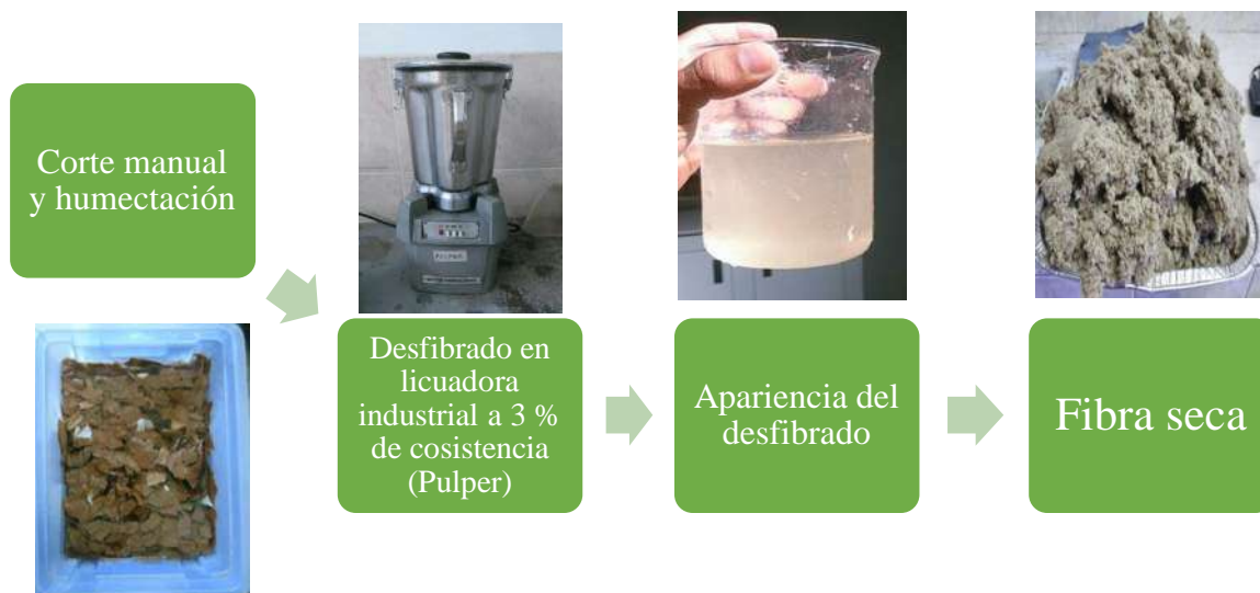
Figura 10. Esquema de preparación de fibra celulósica reciclada.
