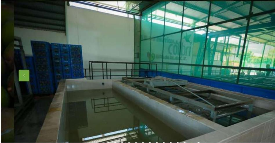
Esta es una de las áreas más importantes, que es donde el mango se procesa a una temperatura, pero esta va a variar dependiendo de los calibres que se estén tratando. El hidrotérmico consta de tinas donde caben 216 cajas de 20 kilos para poder llevar a cabo el proceso.
