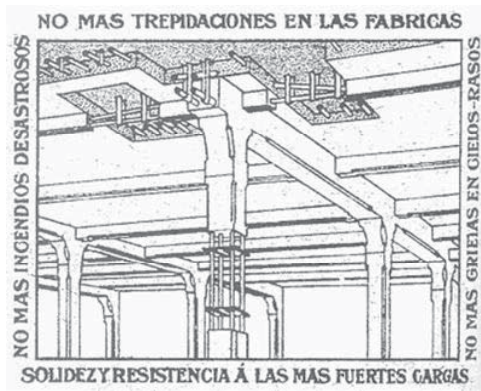
Fig. 1 y 2.- A la izquierda modelo patentado por Hennebique y a la derecha estructura de concreto usada en capilla de la Casa Hogar Soledad de Figaredo.
