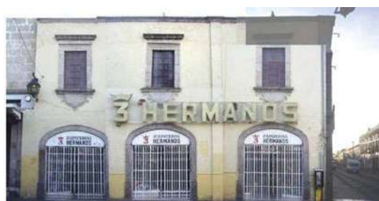
Figs. 11 y 12.- Comparación entre la fachada del plano de 1941 y la fachada actual, en donde al parecer se optó desde su construcción inicial por quitar la ventana de planta baja y centrar el acceso intermedio y el vano de ventana en la planta alta. Archivo particular de Jaime Sandoval, cortesía de Catherine Ettinger y foto del autor.
