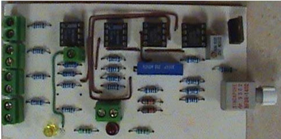
Figura 4.9. Circuito de la etapa de transmisión y mezclado terminado.
