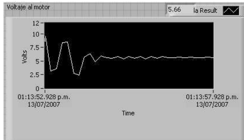
Figura 4.7 Comportamiento del voltaje aplicado al motor colocando 600 RPM en la referencia.
