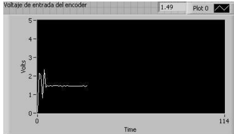
Figura 4.20 Comportamiento del voltaje a la salida del convertidor F/V TC9402, utilizando el control Proporcional-Integral (PI) y colocando 300 RPM en la referencia.
