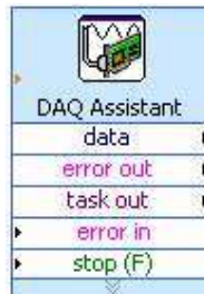
Figura 3.4 Bloque de voltaje analógico de entrada de la tarjeta NI USB-6008
