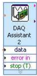
Figura 3.3 Bloque de voltaje analógico de salida de la tarjeta NI USB-6008
