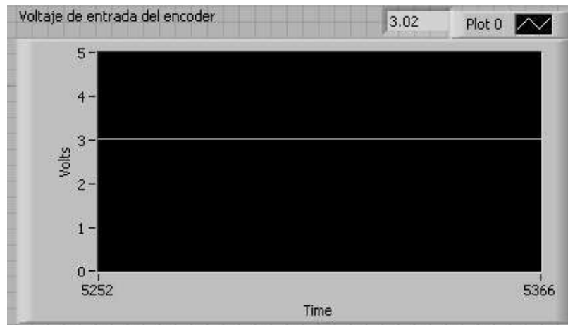
Figura 4.42 Comportamiento del voltaje a la salida del convertidor F/V, utilizando el control Proporcional-Integral-Derivativo (PID) y colocando 750 RPM en la referencia.
