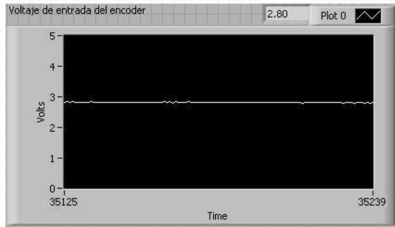
Figura 4.25 Comportamiento del voltaje a la salida del convertidor F/V, utilizando el control Proporcional-Integral (PI) y colocando 700 RPM en la referencia.
