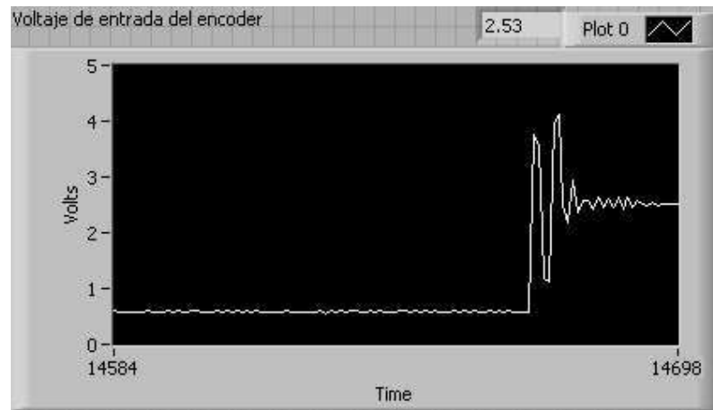
Figura 4.8 Comportamiento del voltaje a la salida el convertidor de F/V colocando 600 RPM en la referencia.
