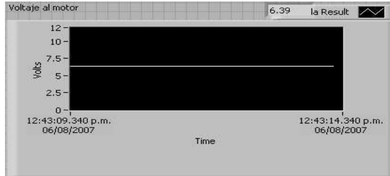
Figura 4.40 Comportamiento del voltaje aplicado al motor, utilizando el control Proporcional-Integral-Derivativo (PID) y colocando 750 RPM en la referencia.
