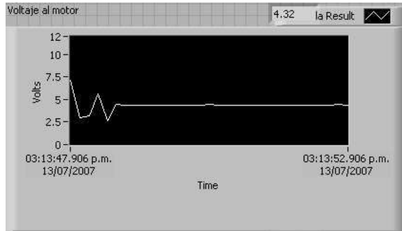
Figura 4.18 Comportamiento del voltaje aplicado al motor, utilizando el control Proporcional-Integral (PI) y colocando 300 RPM en la referencia.
