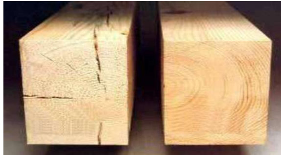
Figura 3.5.4.1.-Diferencia entre el secado natural (izquierda) y Artificial (derecha).
