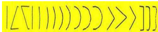
Figura 3.7.1.4.-Perfiles de distintas gubias
