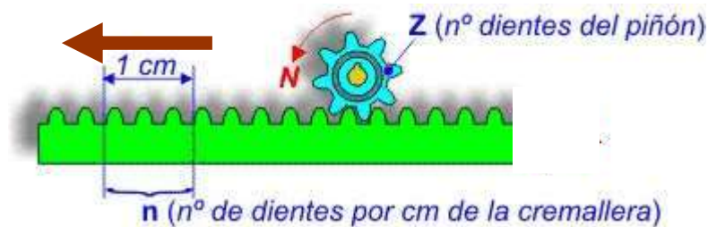
Figura 3.9.2.3.-Factores importantes en el sistema piñón cremallera
