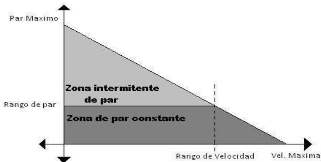
Fig. 3.7 Características Par/Velocidad del BLDC
