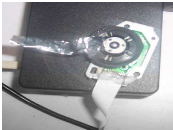
Fig. 4.21 Deformación en la tira de aluminio debido a la velocidad
