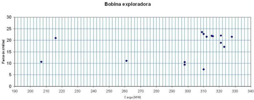
Figura 6.11.- Curva de dispersión de factor de similitud con respecto a la carga
