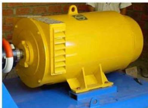
Figura 3.29 Vista de un generador síncrono Negrini de 200KVA
