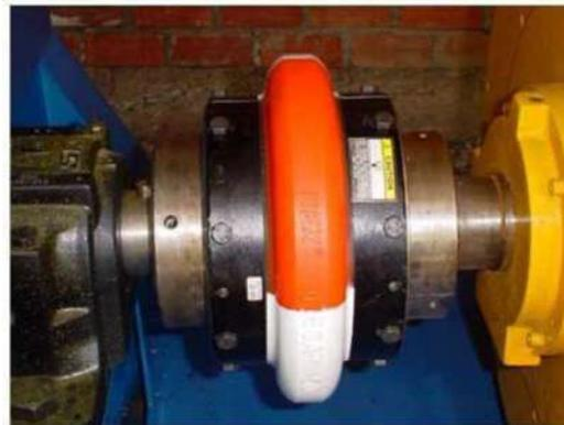
Figura 3.28 Vista de un acople flexible.
