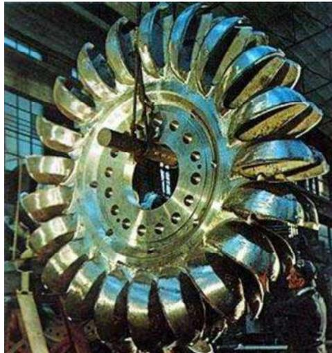
Figura 2.8 Rodete de una turbina Pelton
