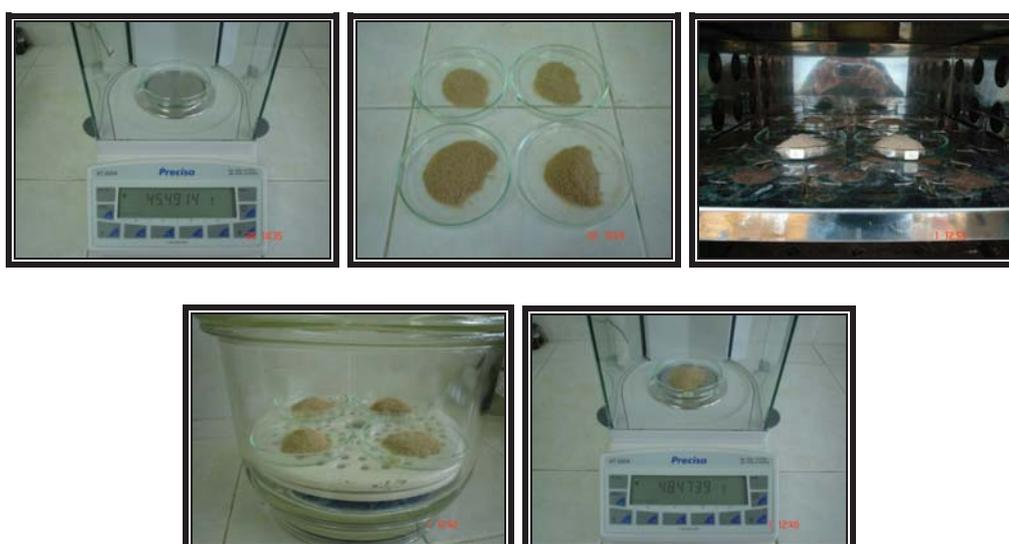
**Figura 7.** Secuencia seguida para la determinación del % de humedad (Fotos: Irak C. R.)
