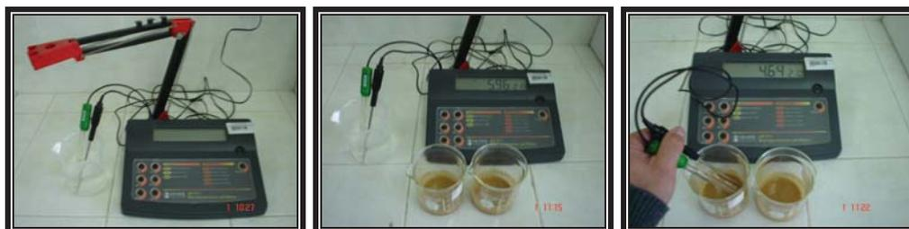
**Figura 9.** Potenciómetro para medir el pH (Fotos: Irak C. R.)
