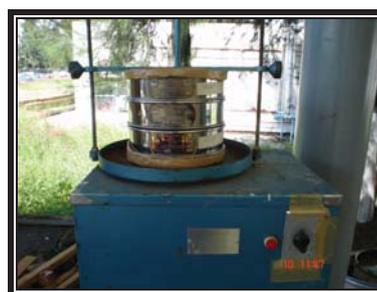
**Figura 6.** Criba Vibratoria Rotap.
