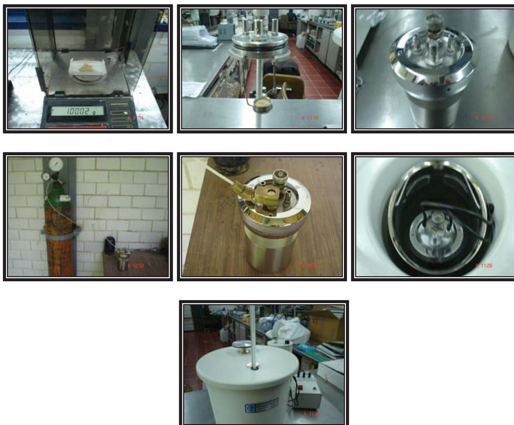
**Figura 16.** Detalles para preparar la bomba calorimétrica utilizada (Fotos: Irak C. R.)
