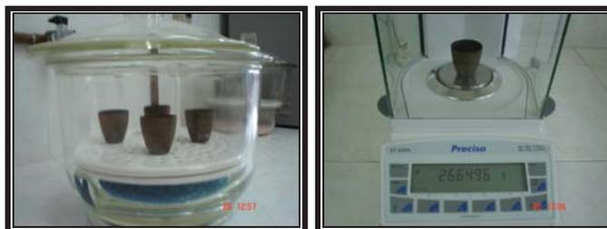
**Figura 10.** Secuencia seguida para la obtención de cenizas (Fotos: Irak C. R.)
