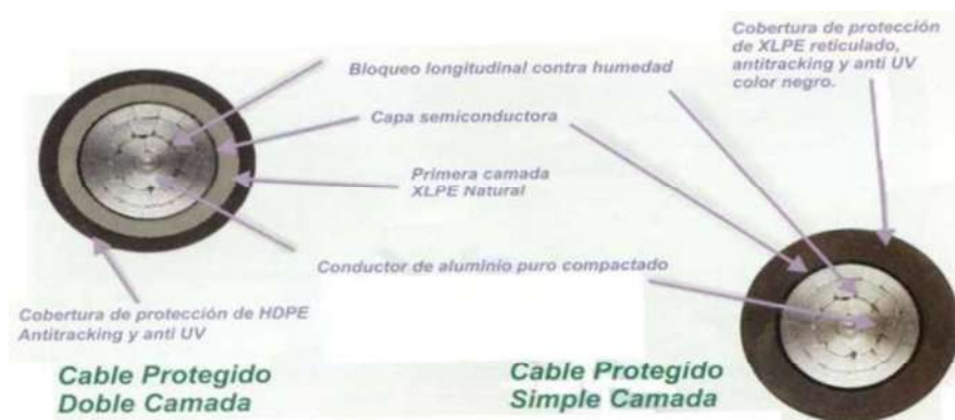
Figura 3.33.- Partes principales que componen al conductor semiaislado.
