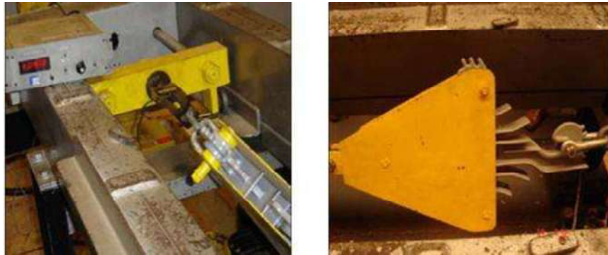
Figura 3.28.- Aspecto físico de la prueba de tracción realizada al espaciador.
