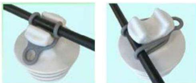
Figura 3.3.- La figura de la izquierda muestra el amarre mediante el anillo para conductores de paso y la figura de la derecha para conductores que requieren hacer alguna deflexión.
