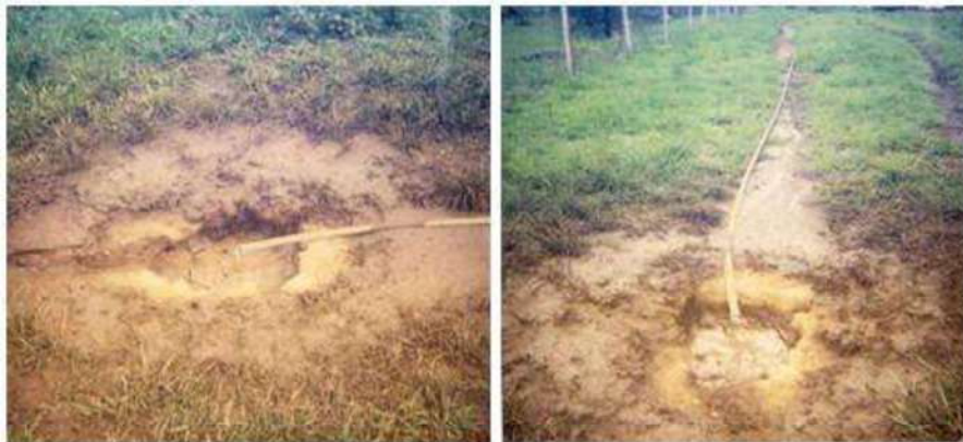
Figura 4.7.- Conductor semiaislado reventado por descarga atmosférica, cayendo en camino de personas.
