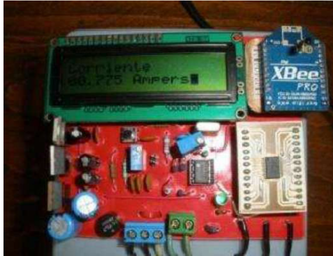
Figura 38. Valor de corriente medido por el equipo construido
