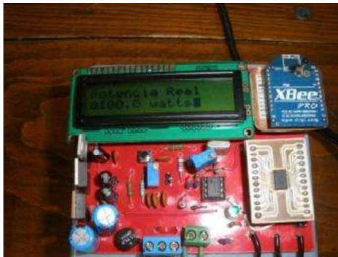
Figura 39. Valor de potencia real por el equipo construido
