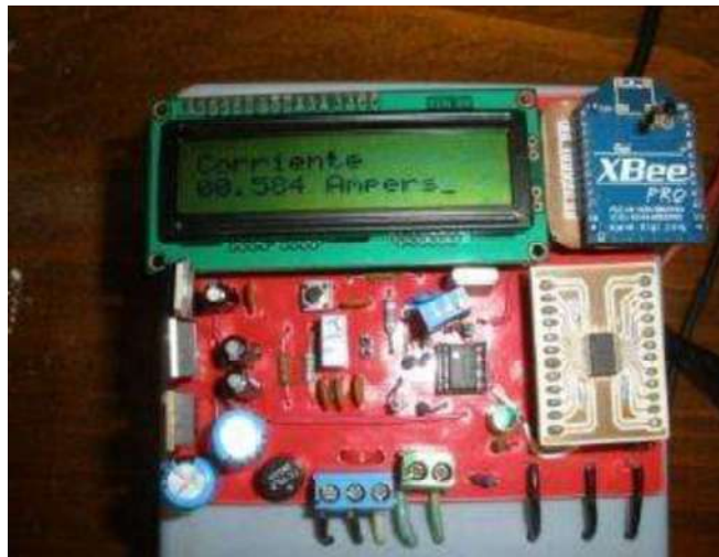
Figura 33. Valor de corriente medido por el equipo construido
