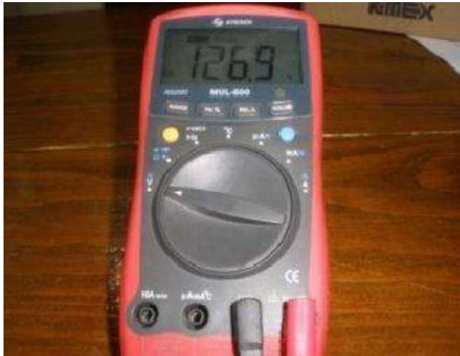
Figura 34. Valor de voltaje medido el multímetro.
