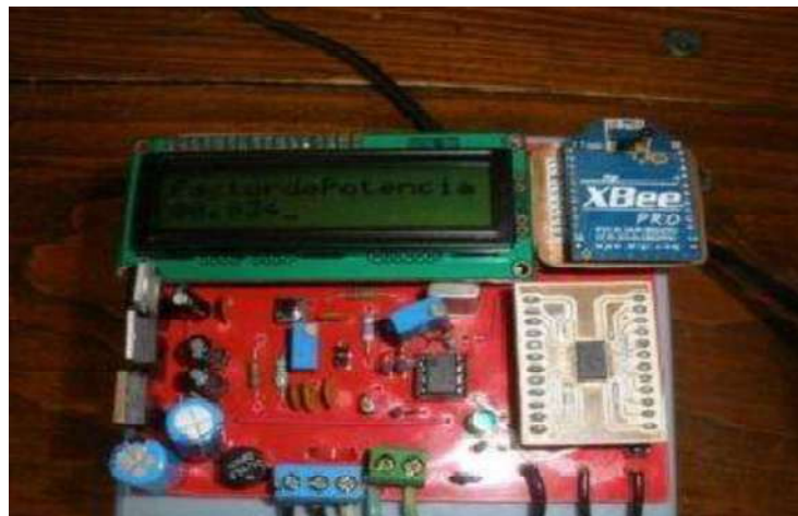
Figura 41. Valor del F.P medido por el equipo construido
