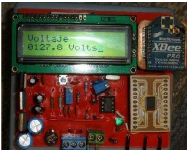
Figura 35. Valor de voltaje medido por el equipo construido.
