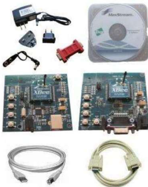
Figura 5.2 Kit de desarrollo ZigBee de MaxStream.
