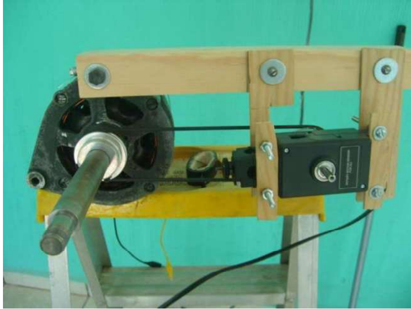
Figura 4.11 Montaje del sensor de velocidad a) muestra lado frontal; b) lado trasero; c) muestra por completo el acople
