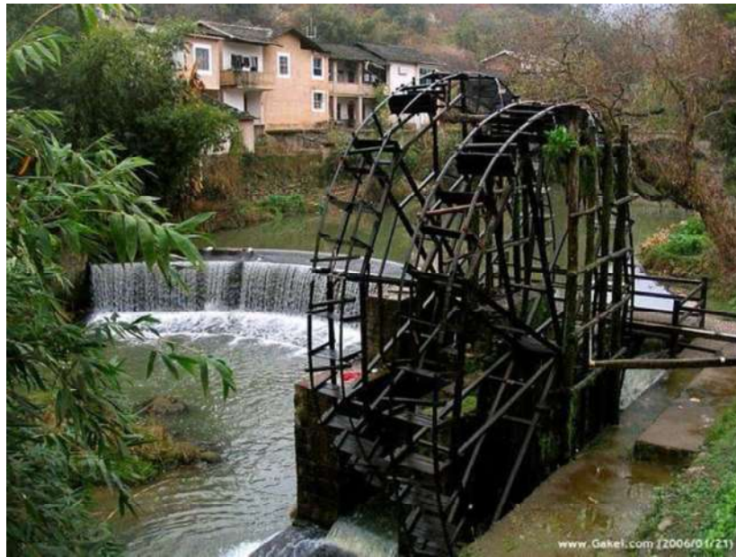
Figura 2.4 Molino para bombear agua
