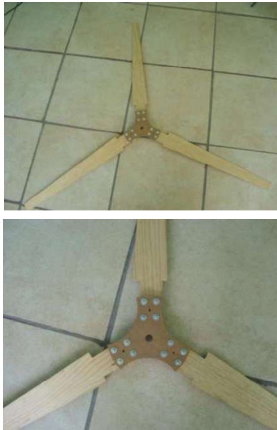
Figura 3.14 Forma del núcleo y su instalación
