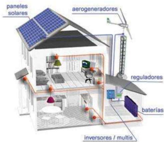
Figura 2.18 Casa habitación con un aerogenerador y paneles solares como fuente auxiliar
