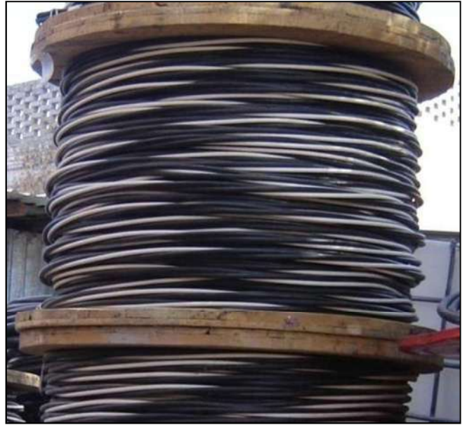
Fig. 6.13 Carrete de 500 mts cable triplex.
