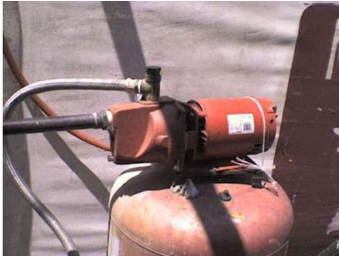
Figura 2.5 Motobomba JET utilizada para riego.
