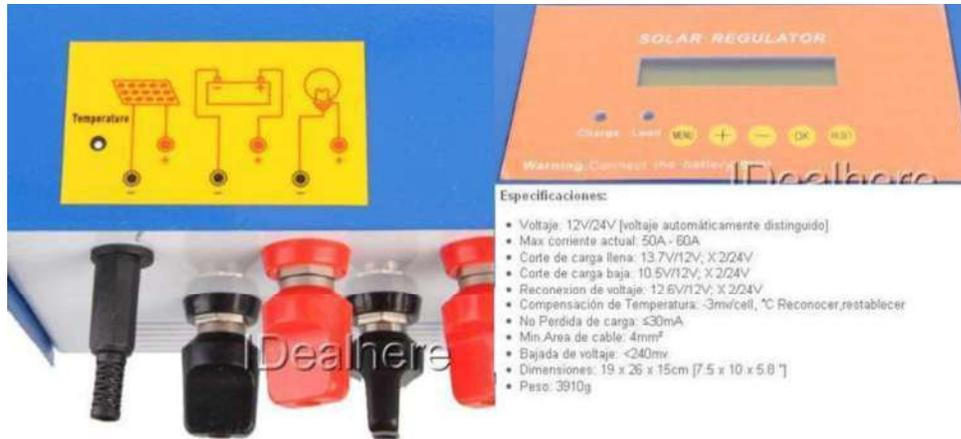
Figura 4.5 Solar cargador regulador 50A 12v/24v.
