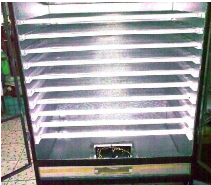
Figura 3.8.- Unidad Calefactor Montado en el Deshidratador.
