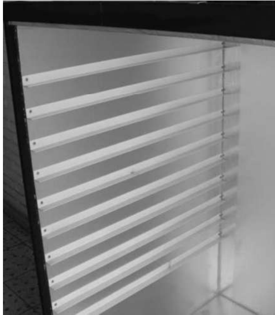
Figura 3.5.- Guías de Bastidores en cara lateral del Deshidratador.
