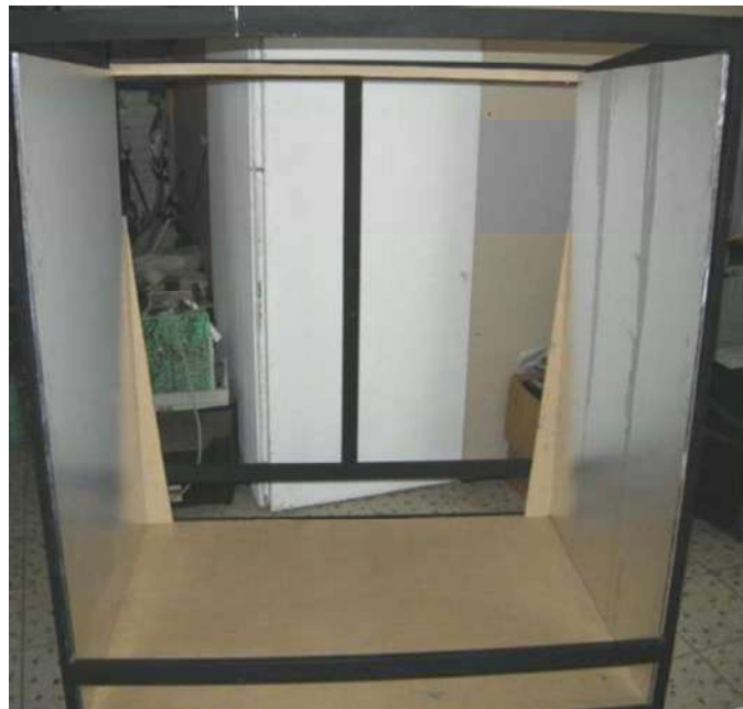
Figura 3.4.- Caras laterales con placa metálica adheridas con adhesivo al MDF.
