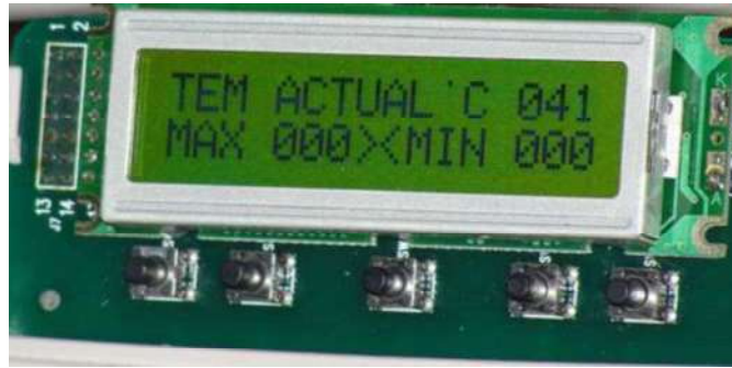
Figura 5.1.- Información desplegada en el Display del CETDX.
