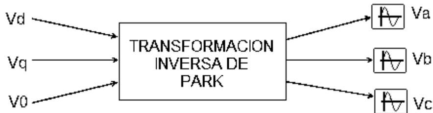
Figura 3.8 diagrama de bloque de la transformación inversa de Park.
