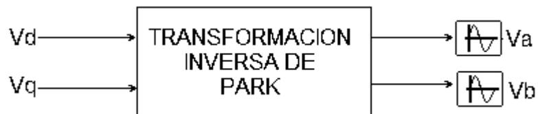
Figura 3.12 Transformación inversa de Park reducida
