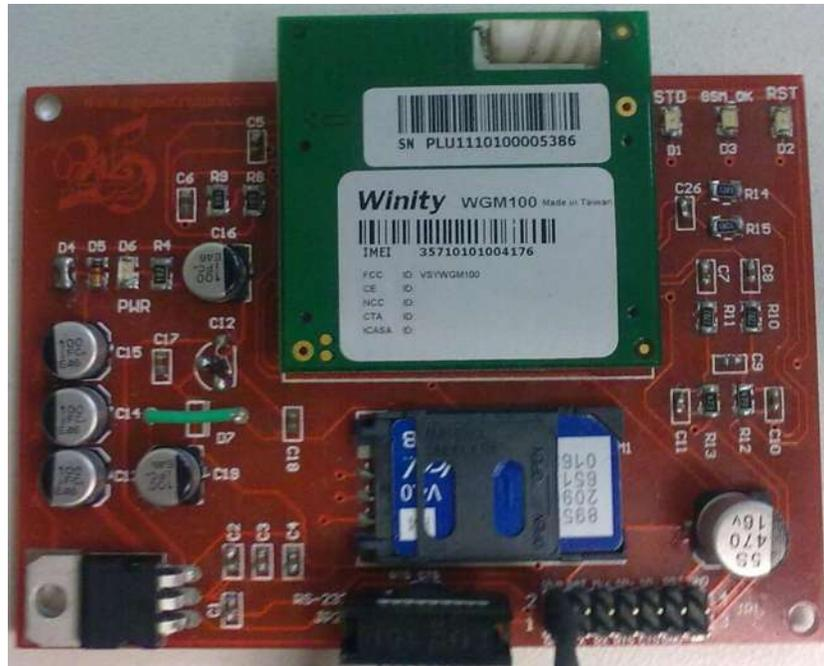
Figura 4: Tarjeta de evaluación para el modem GSM.
