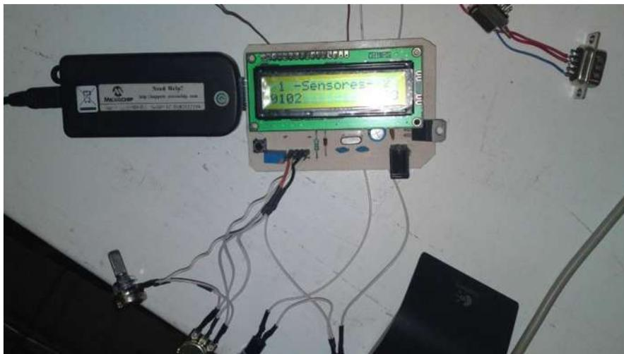
Figura 32: Módulo sensor de voltaje.
