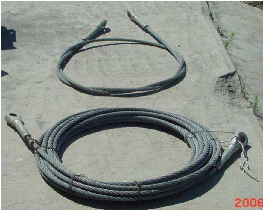
Figura 3.25 Cable de acero para unir dos columnas (Violín)
