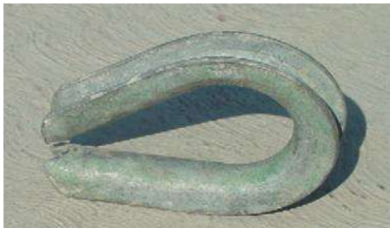
Figura 3.17 Guarda cabos para cable de acero 9/16 in
