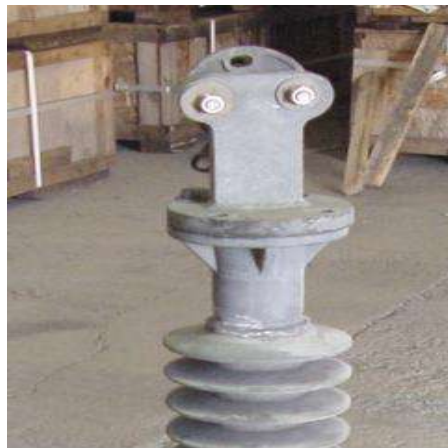
Figura 3.16 Adaptador para ensamble de conjunto de herraje
