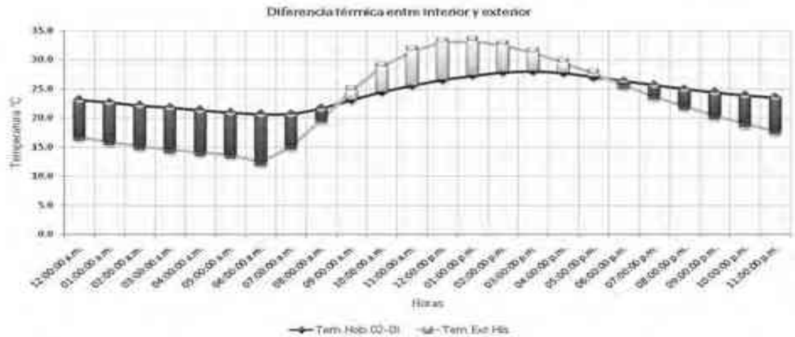
Fig. 42. Diferencia térmica promedio al interior y exterior de la vivienda Sánchez por día típico durante el mes de mayo. Fuente: hobo VS02-01 datos interiores, estación meteorológica I6197 datos exteriores.
