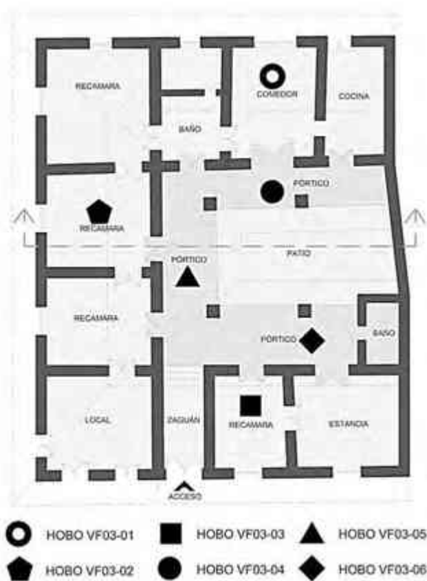
Fig. 6l. Croquis de ubicación de instrumento de monitoreo al interior de la vivienda Fajardo durante la temporada con clima estacional cálido. Fuente: J. J. Segura Granados.
