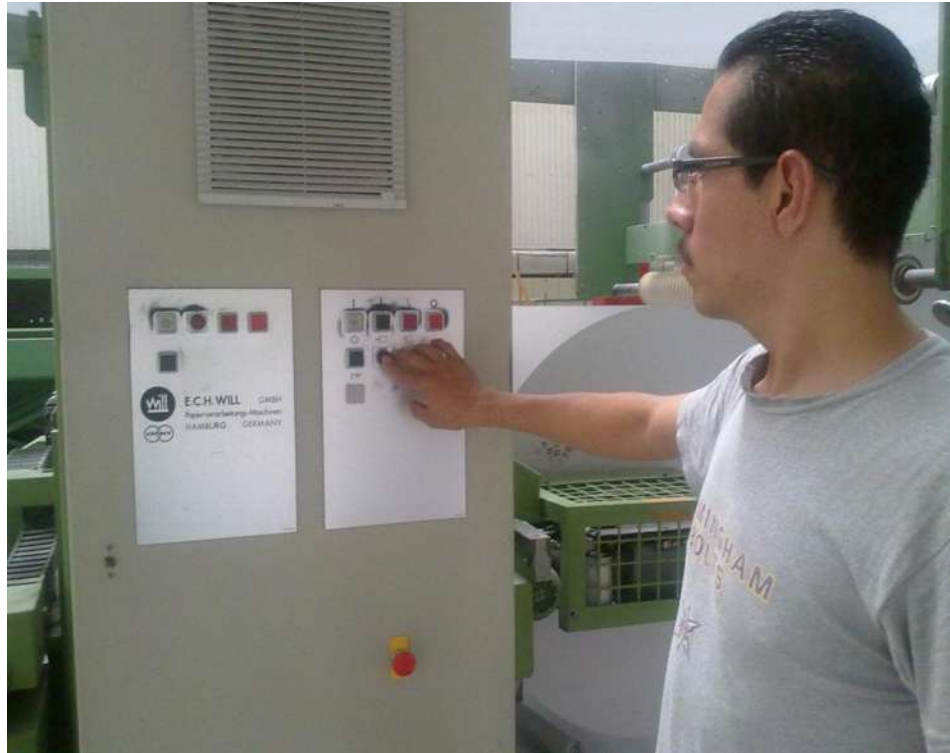
Figura 4.5 Acenso y descenso del mandril de la máquina Will.
