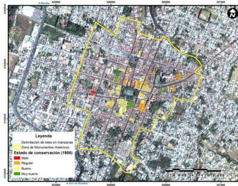
Figura 31. Estado de conservación de los monumentos catalogados 1986
