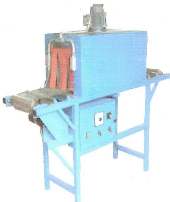
Figura 1. 3 Horno para secado de suela y planta y activado de pegamento. EM-HCSAPS-270
