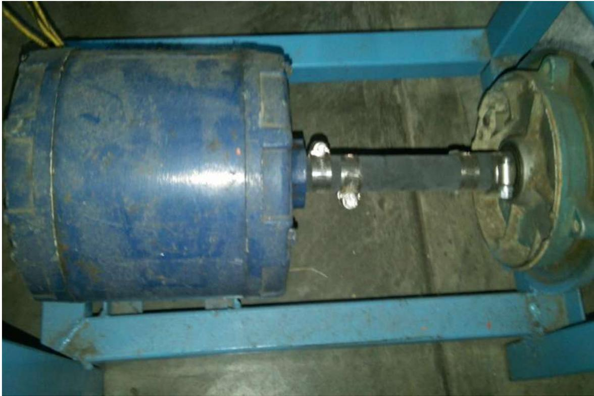
Fig. 4.12 - Acoplamiento del Motor Trifásico.
