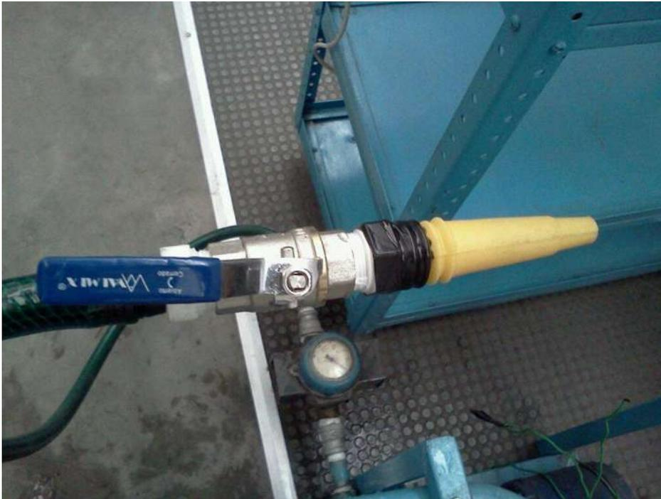
Fig. 4.11 - Válvula de esfera acoplado con la tobera.
