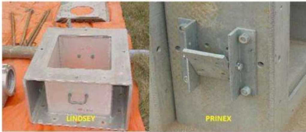
Figura 2.5 Diferencia entre la sección caja Lindsey y Prinex.
