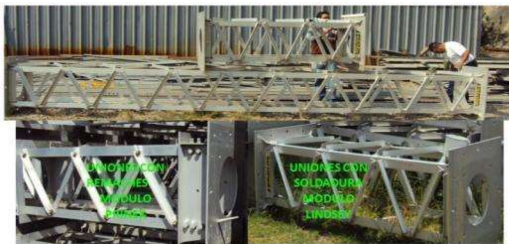
Figura 2.7 Diferencia entre módulos Prinex y Lindsey.
