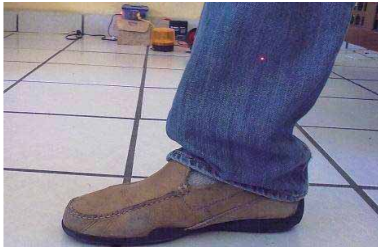
Fig. 5.12 Prueba de interrupción de la señal del rayo laser.
