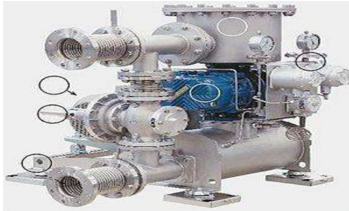
Figura 4-7 Compresor de pistón con soplador para biogás (estacionario).
