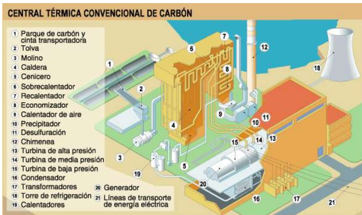
Figura 2.3 Diagrama esquemático de una central térmica de carbón convencional.
