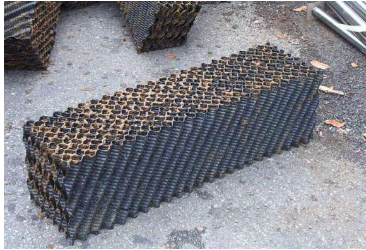
Figura 3.7 Panel de relleno de torre de enfriamiento con señales de corrosión.
