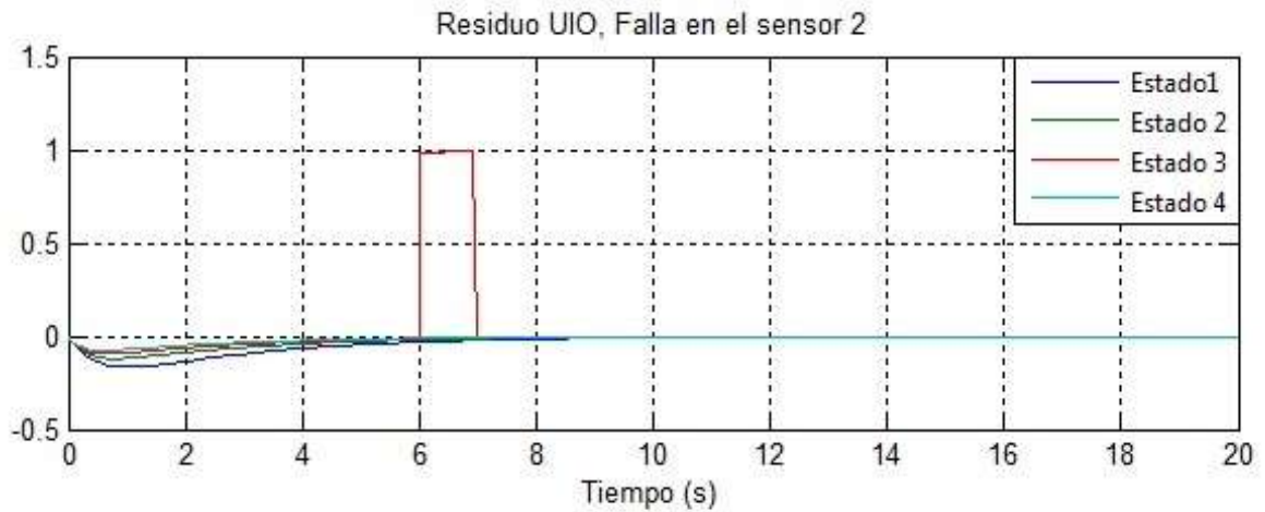
Figura 4.4: Residuo en condición de falla en el sensor 2
