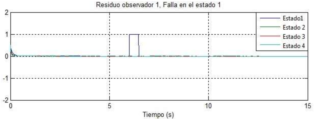
Figura 4.26: Residuos generados en condición de falla en el estado 1
