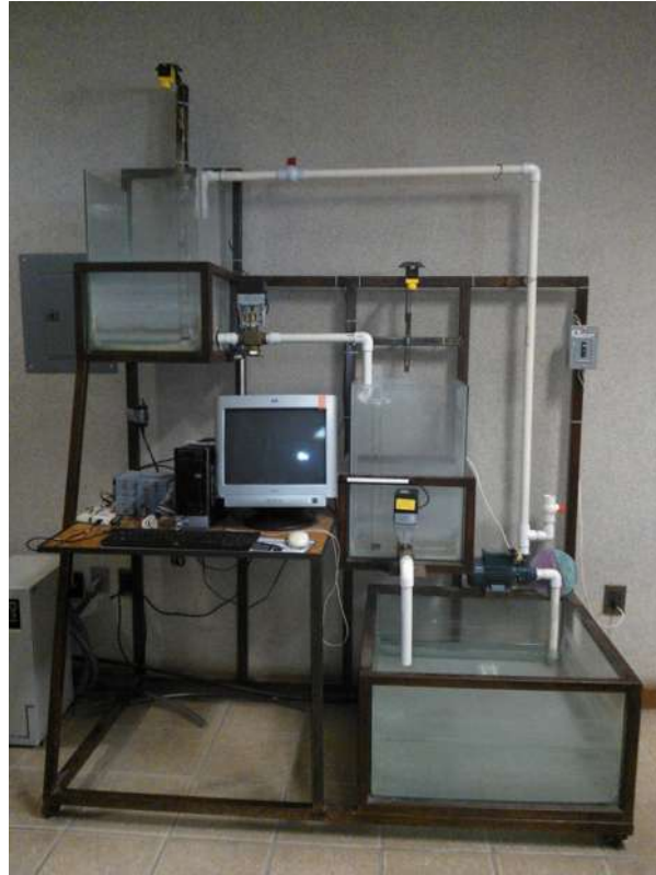
Figura 4.1: Sistema Hidráulico de Dos Tanques
