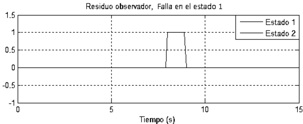
Figura 4.11: Residuo generado en condición de falla en el sensor 1
