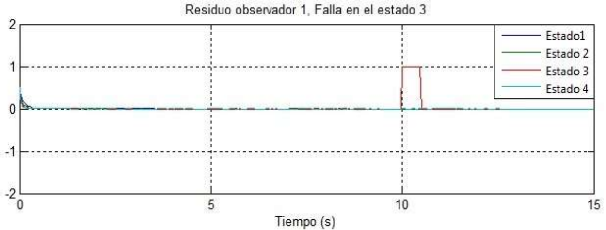
Figura 4.27: Residuos generados en condición de falla en el estado 3
