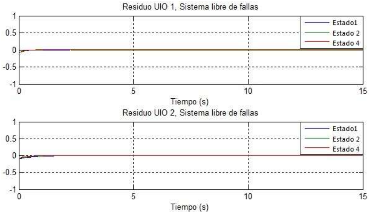
Figura 4.6: Residuos generados en condiciones libres de fallas.
