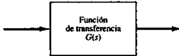
Figura 2.1: Elemento de un diagrama de bloques
