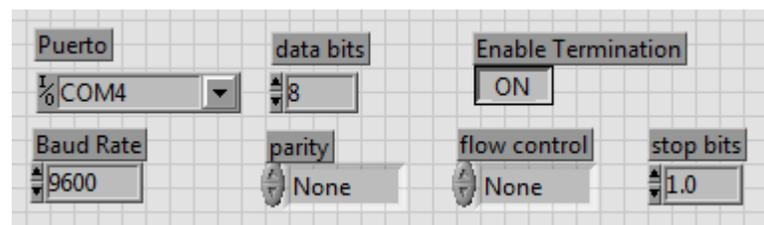
**Figura 4.21** Configuración de los controles del puerto serial.
