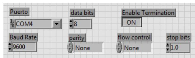
**Figura 3.26** Controles de configuración del puerto serial.
