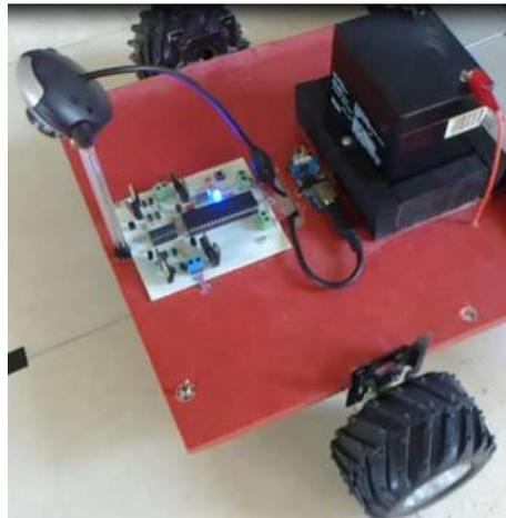
**Figura 4.18** Montaje y ubicación de webcam, circuito impreso y batería.
