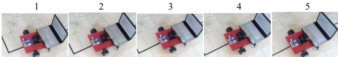
**Figura 5.14** Secuencia de retroceso del prototipo seguidor de línea.
