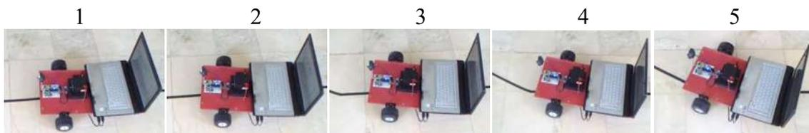
**Figura 5.8** Secuencia de desplazamiento a la derecha del prototipo seguidor de línea.
