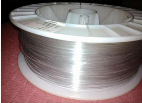
Figura 4.1, fibra óptica plástica.
