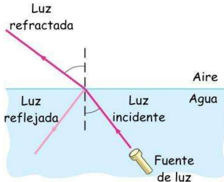
Figura 2.1 Refracción de la luz
