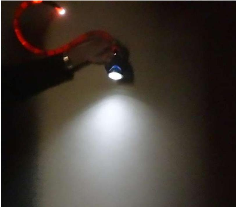
Figura 4.7. Iluminación con fibra óptica.
