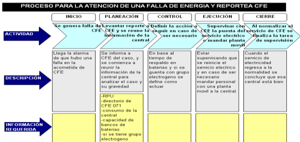
Figura 43: Proceso de Atención de una Falla
