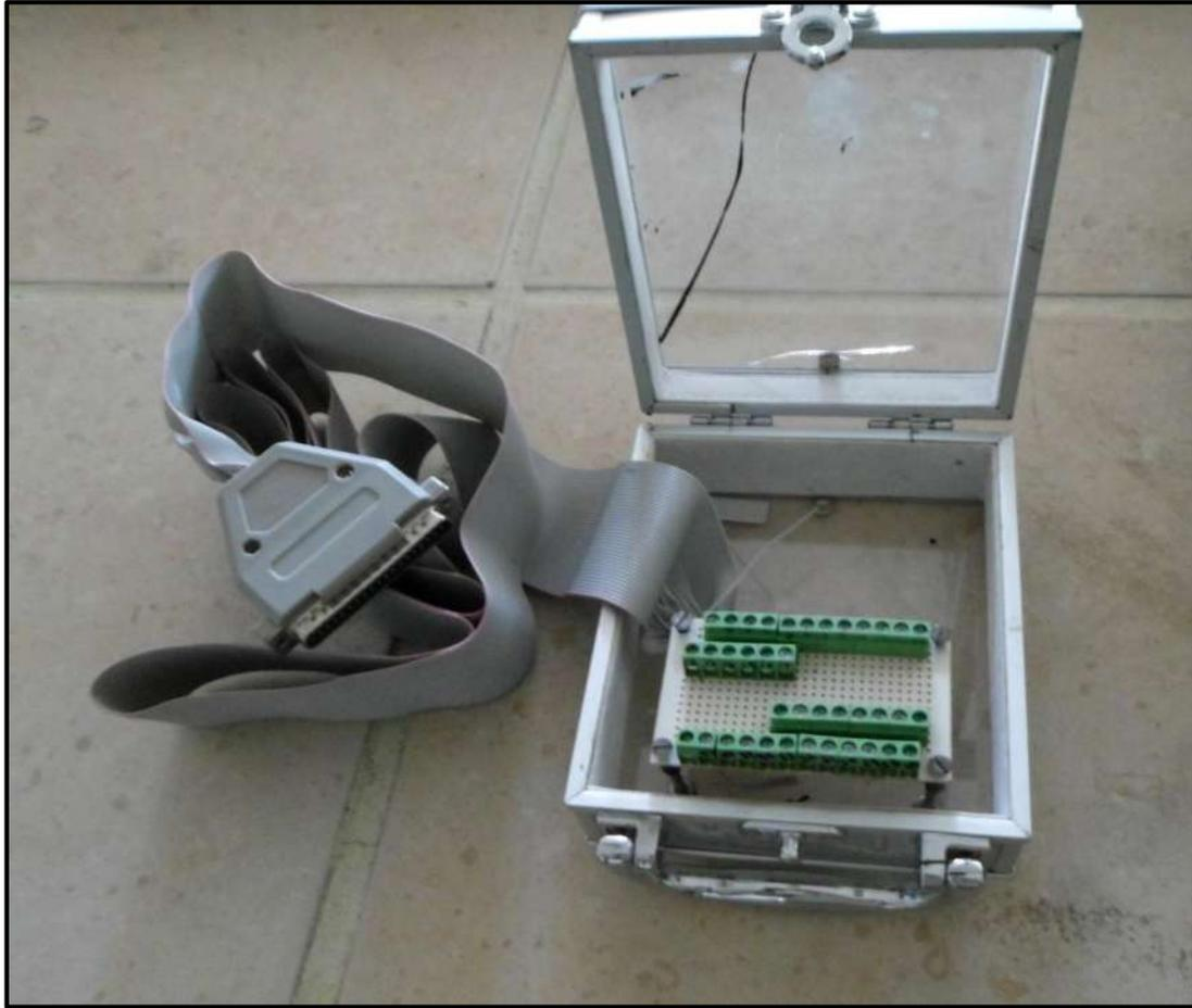
Figura 3.3 Cable conector implementado para el acceso a los canales de la tarjeta.
