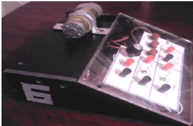
Figura 4.1. Aspecto externo del módulo de control de velocidad de un motor de CD.
