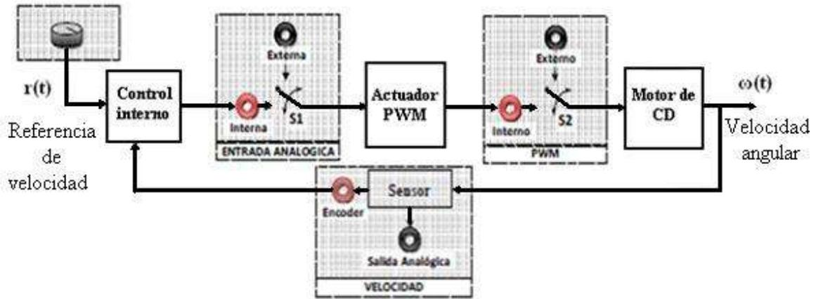
Figura 4.4. Diagrama de bloques y conexión del panel externo.
