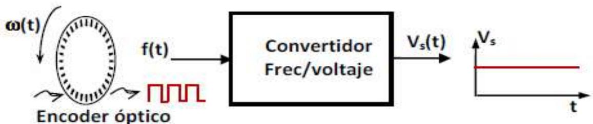
Figura 4.6. Esquema del sensor de velocidad.
