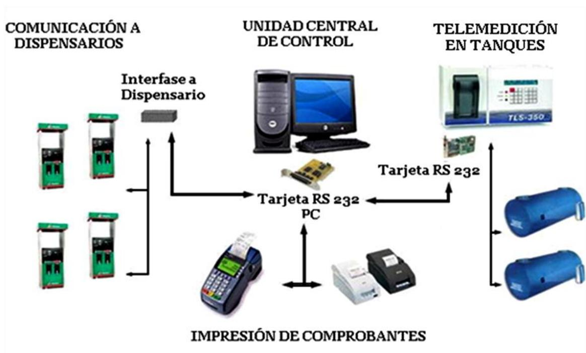
Figura 2.6 Diagrama de control distribuido de la compañía PEMEX.
