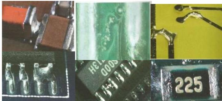
FIGURA 7 Puentes De Soldadura Y Corto Circuito.
