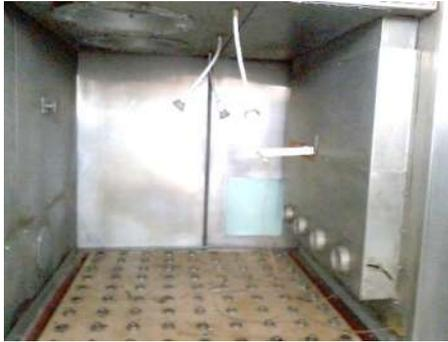
**FIGURA 16 Interior De Cámara Halt**
