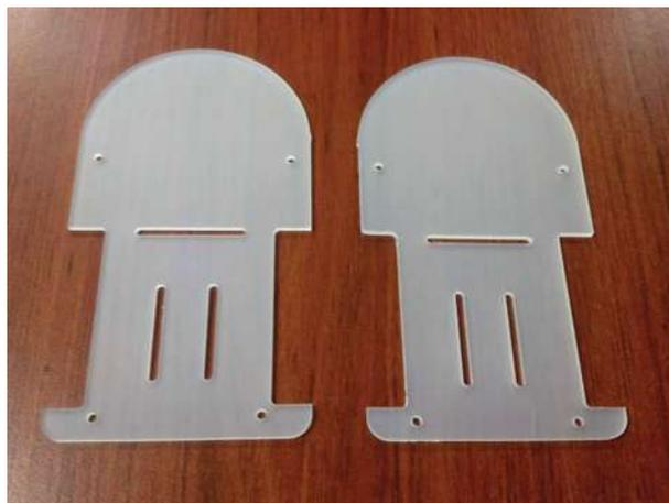
Figura 4.13: Placas del robot seguidor de línea.
