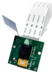
Figura 4.2: Cámara Pi diseñada para la conexión en un puerto SCI de la Raspberry Pi.
