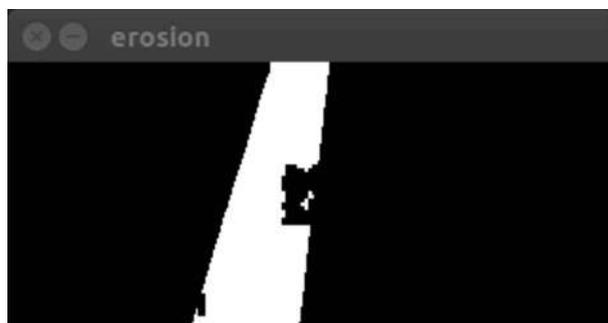
Figura 5.6: Eliminación de ruido por Erosión.
