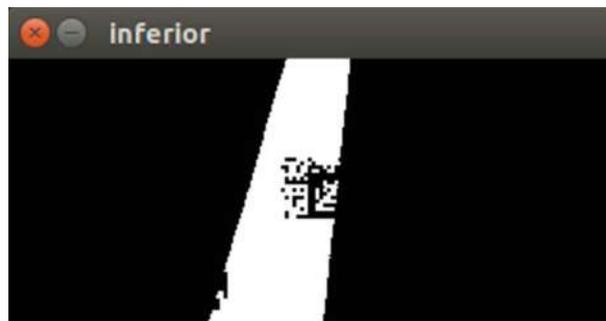
Figura 5.4: Imagen binarizada de la imagen original, se muestra solamente la mitad del alto de la imagen.
