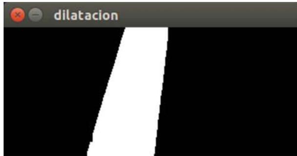
Figura 5.5: Eliminación de ruido por Dilatación.
