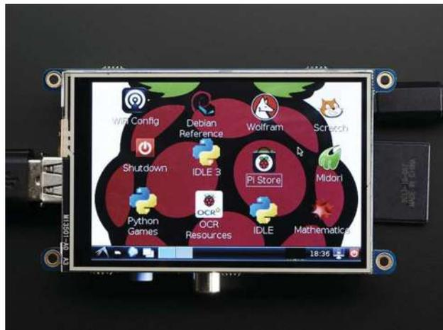
Figura 4.11: Display de 3.5" para la Raspberry Pi.
