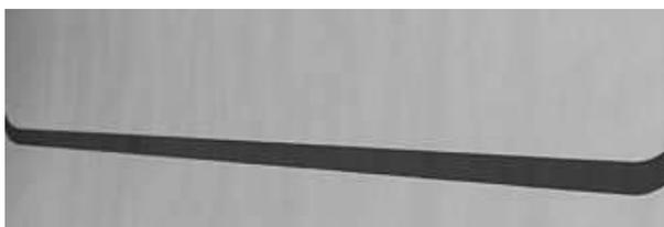
Figura 6.1: Pista de línea recta en papel bond de longitud 1.7 metros, espesor de 2cm., color de la línea negro con fondo blanco.
