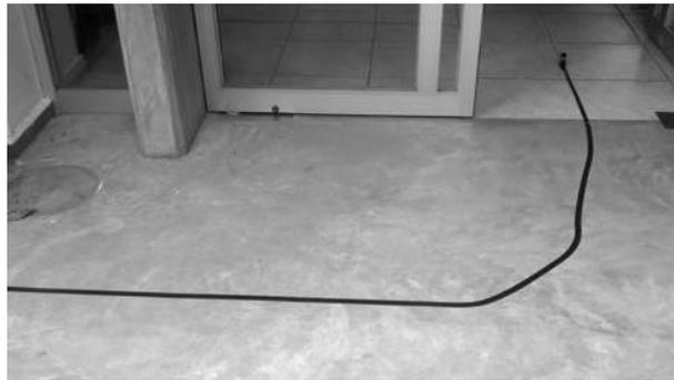
Figura 6.7: En la imagen se muestra la trayectoria de línea de color negro curva trazada en piso de concreto para el robot seguidor de línea.
