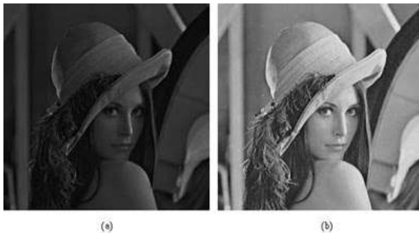
Figura 2.3: Aumento de contraste: (a) imagen oscura debido a que su rango de grises es reducido, (b) ecualización del rango de grises.
