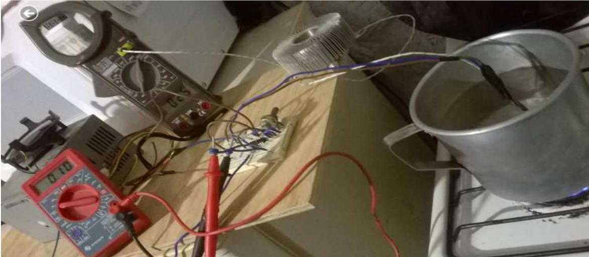
Figura 4.11. Conexión del puente de Wheatstone con el amplificador de instrumentación.
