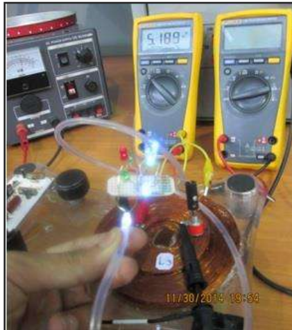
Figura 4.32 Iluminación con fibra Óptica con L_3 como inducido
