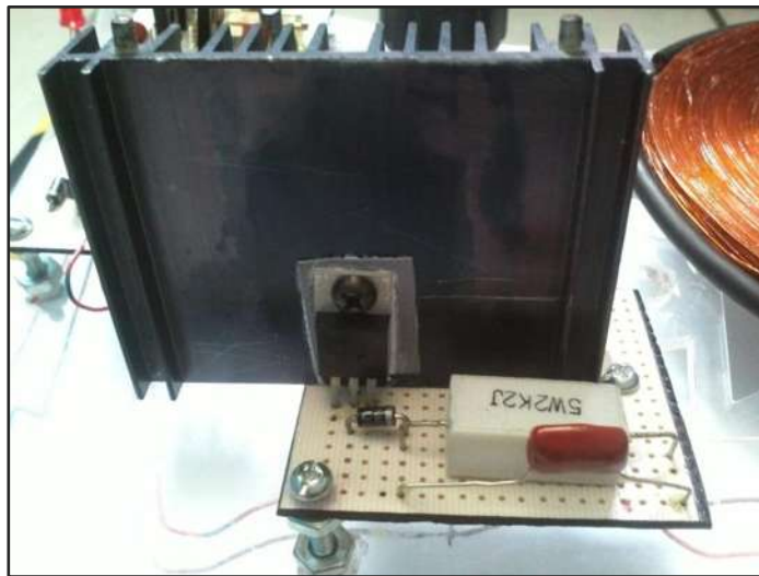
Figura 3.11 El Mosfét en la etapa de potencia
