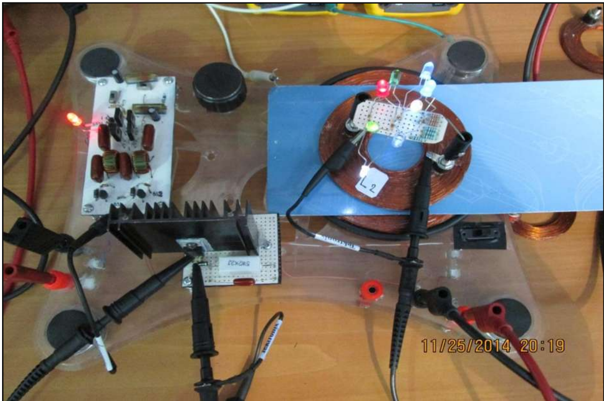
Figura 4.16 Bobina L_2 inducida alimentando diodos LED útiles en iluminación
