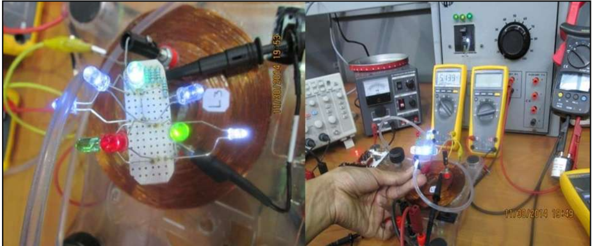
Figura 4.15 El dispositivo F.C.E.I. para iluminación con fibra óptica
