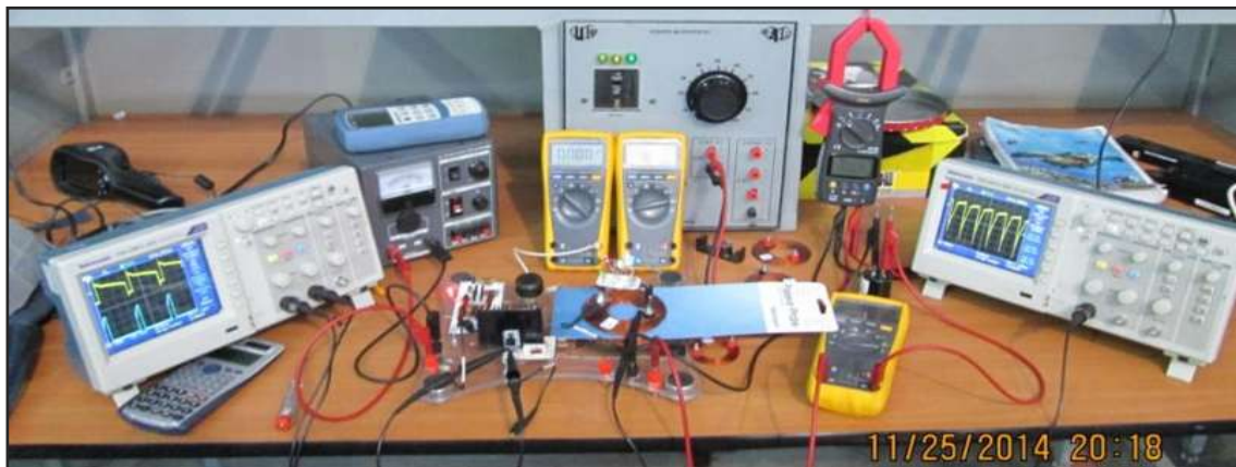
Figura 4.33 Dispositivo F.C.E.I. montado en el laboratorio con L_3 como inducido
