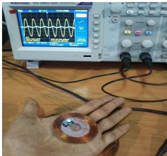
Figura 4.47 Inducción electromagnética sin cables
