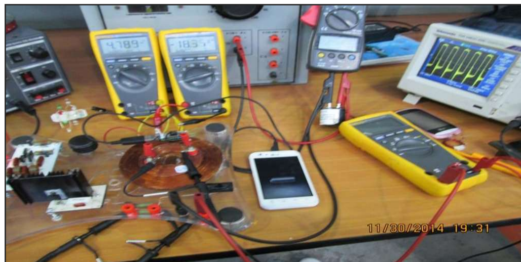
Figura 4.40 Fuente de Energía Inalámbrica F.C.E.I. en operación con un dispositivo móvil
