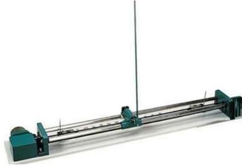
Figura 1. 8: Péndulo invertido de Shandong xingke intelligent technology
