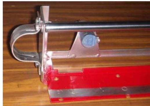
Figura 2. 10: Abrazadera omega al costado izquierdo de la base.
