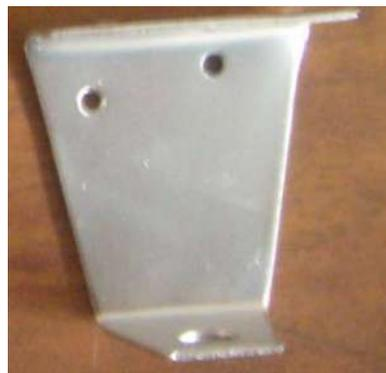
**Figura 2. 16: Soporte para la articulación del péndulo.**
