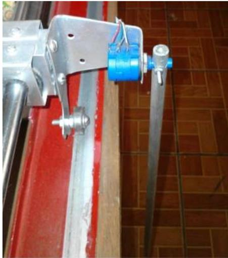
**Figura 2. 20: Montaje del péndulo sobre el sensor en el carro.**
