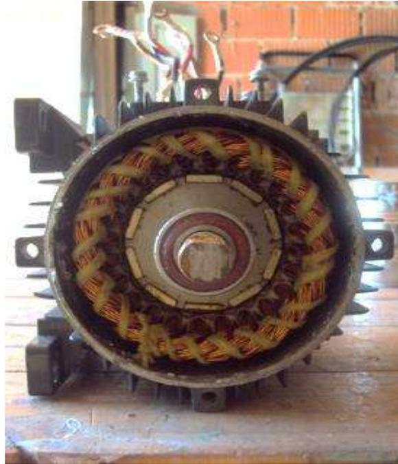
Figura 2.9 Máquina síncrona de imanes permanentes.
