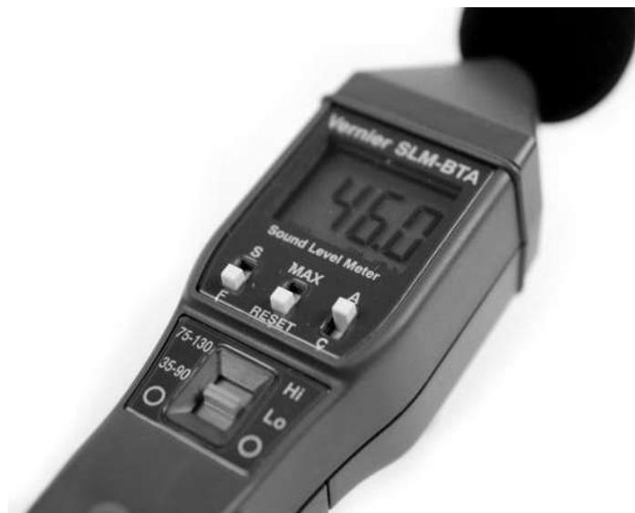
Figura 3.23 Vista de los tres interruptores del sensor SLM-BTA.
