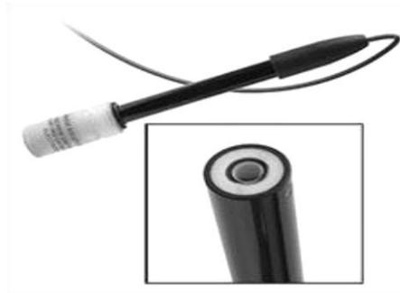
Figura 3.17 Sensor Plano de Ph.
