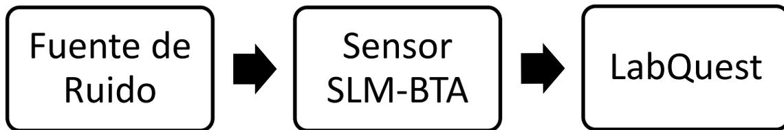
Figura 3.26 Diagrama de obtención de gráfica con Logger Pro.
