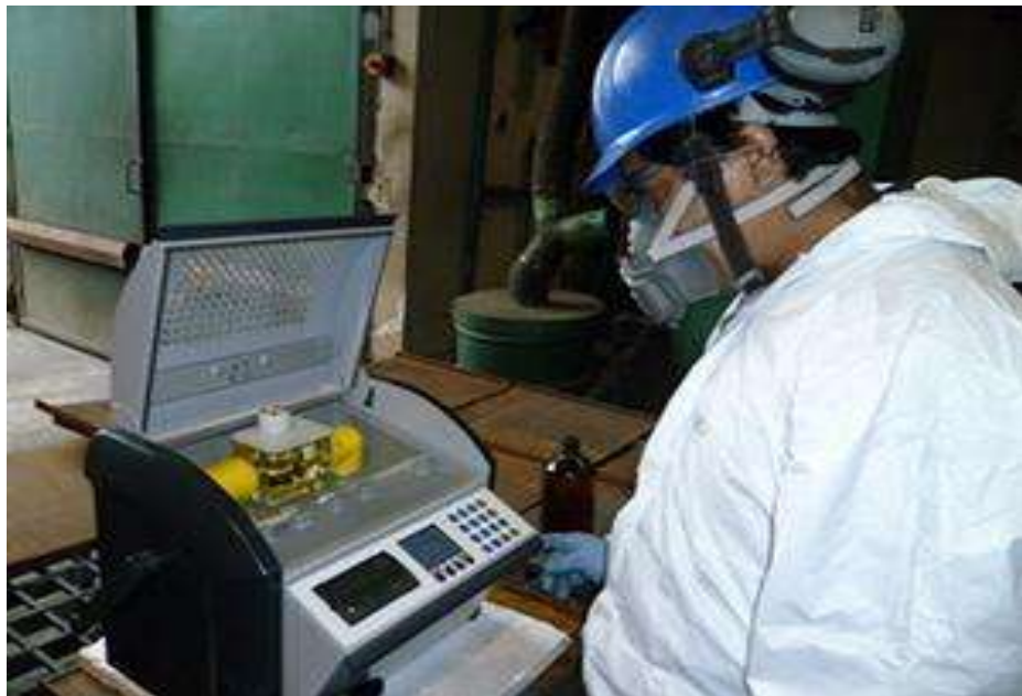
Figura 25.- Realización de la prueba de Rigidez dieléctrica del aceite de un transformador.
